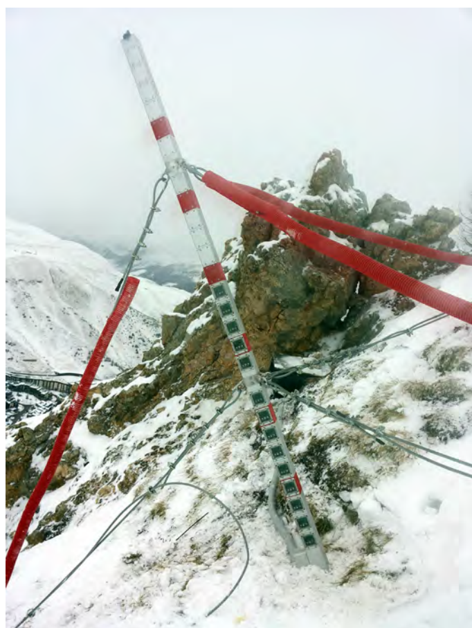
Système de mesure de hauteur de neige – Tignes.
