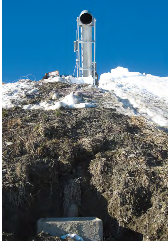
Système infrasonique avec capteur enterré – Les Contamines.
