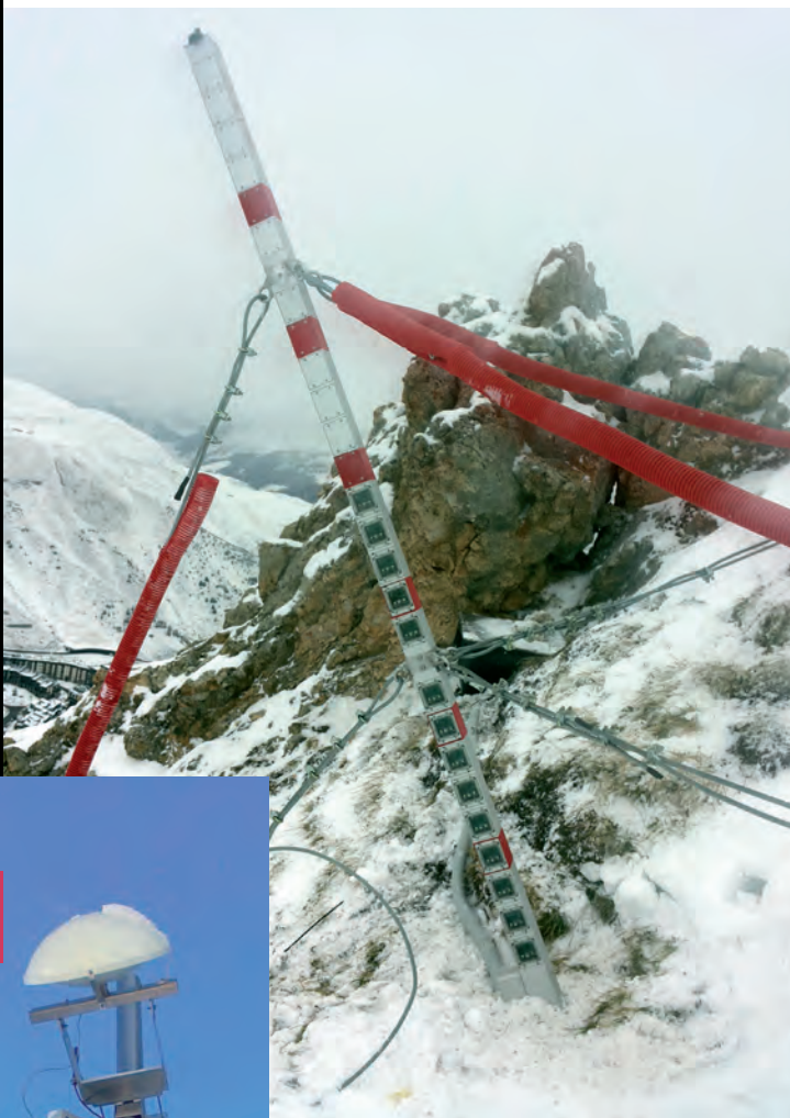
Sistema de medición de altura de nieve - Tignes, Francia
